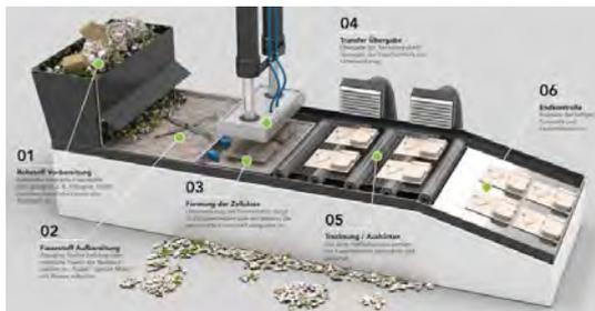
Abb. 43. Herstellungsprozess eines Faserformteils (Faserguss) im Nassverfahren.
