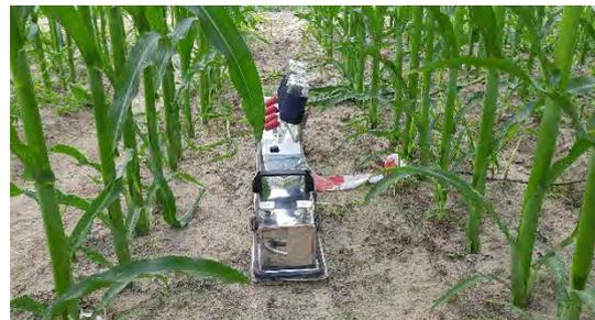
Abb. 64 Messung von bodenbürtigen CH<sub>4</sub>- und N<sub>2</sub>O-Emissionen im Pflanzenbestand
