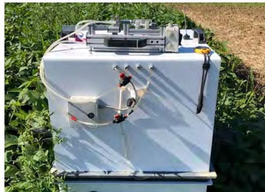
Abb. 91. Lachgasmessung in Sojabohnen mit der Closed-Chamber-Methode.
