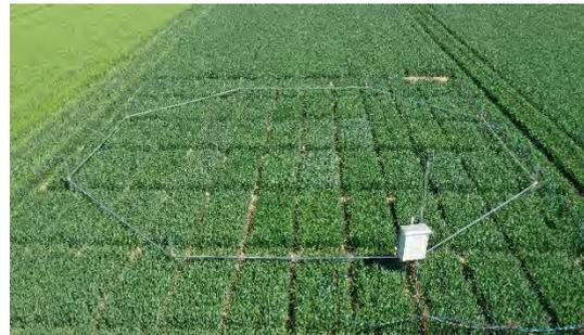
Abb. 81. FACE-Anlage des JKI am Standort Braunschweig-Bundesallee in einem Weizenversuch. Innerhalb des Ringes/Achtecks wird die CO<sub>2</sub>-Konzentration auf 600 ppm erhöht.
