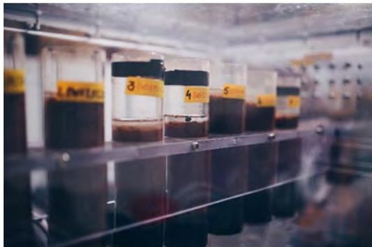
Abb. 8. Inkubationsexperimente zur Quantifizierung des CO<sub>2</sub>-Entnahmepotentials verschiedener Kombinationen von Gesteinsmehl und Pflanzenkohle. (Foto: T. Amann)
