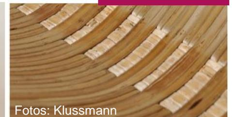
Abb 03.: Weidenholzfasern und Weidenholztextil, händisch und teilautomatisiert gefertigt (c) und Foto: Bau Kunst Erfinden
