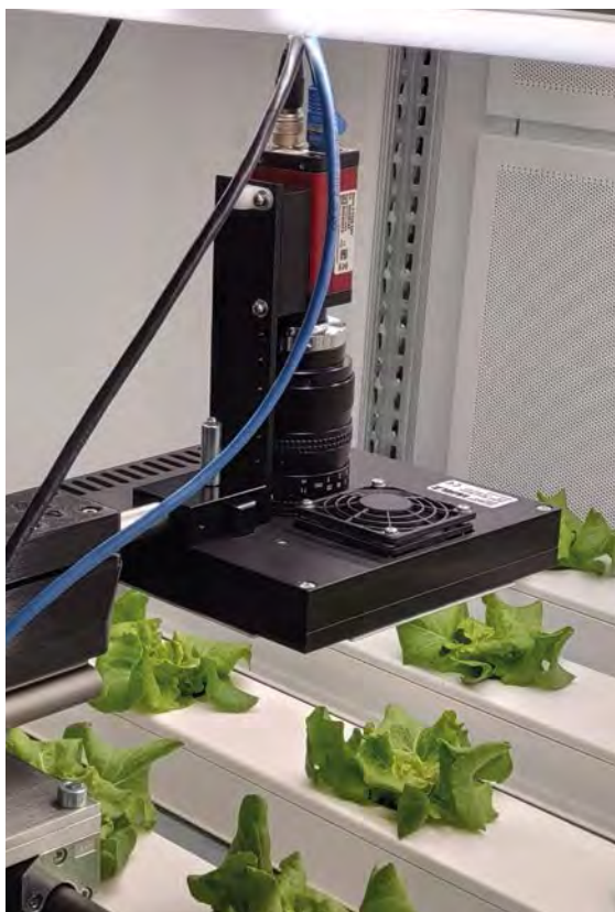
Messung der Fluoreszenz zur Zustandserfassung der Pflanzen
