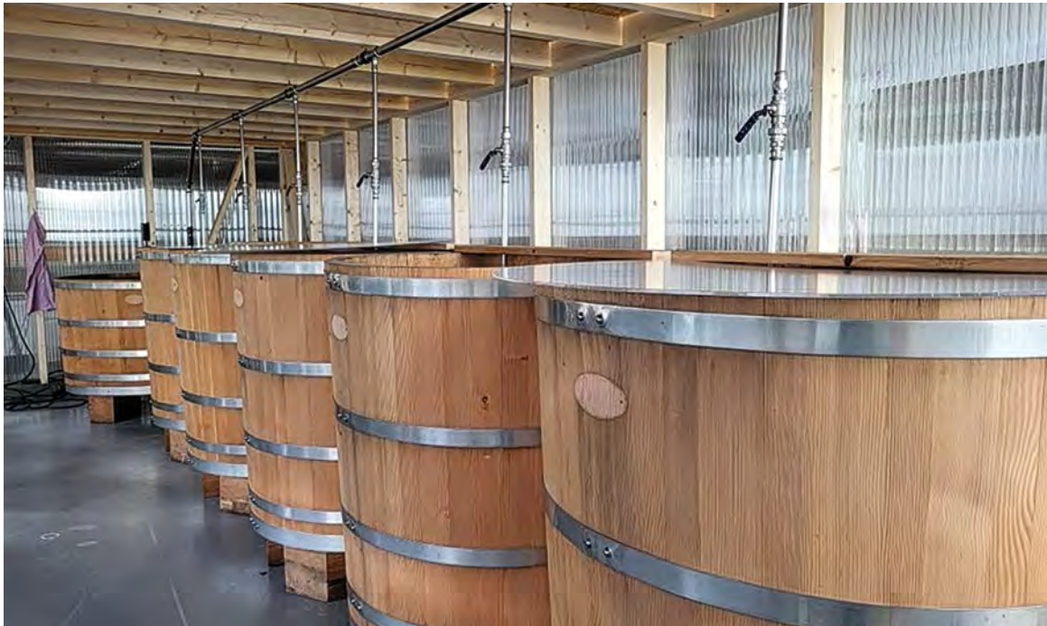
Holzfässer zur Garnelenproduktion als Bestandteil einer CEA-Anlage
