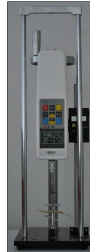
Kraftmessung beim Trennen der Schotenwände
